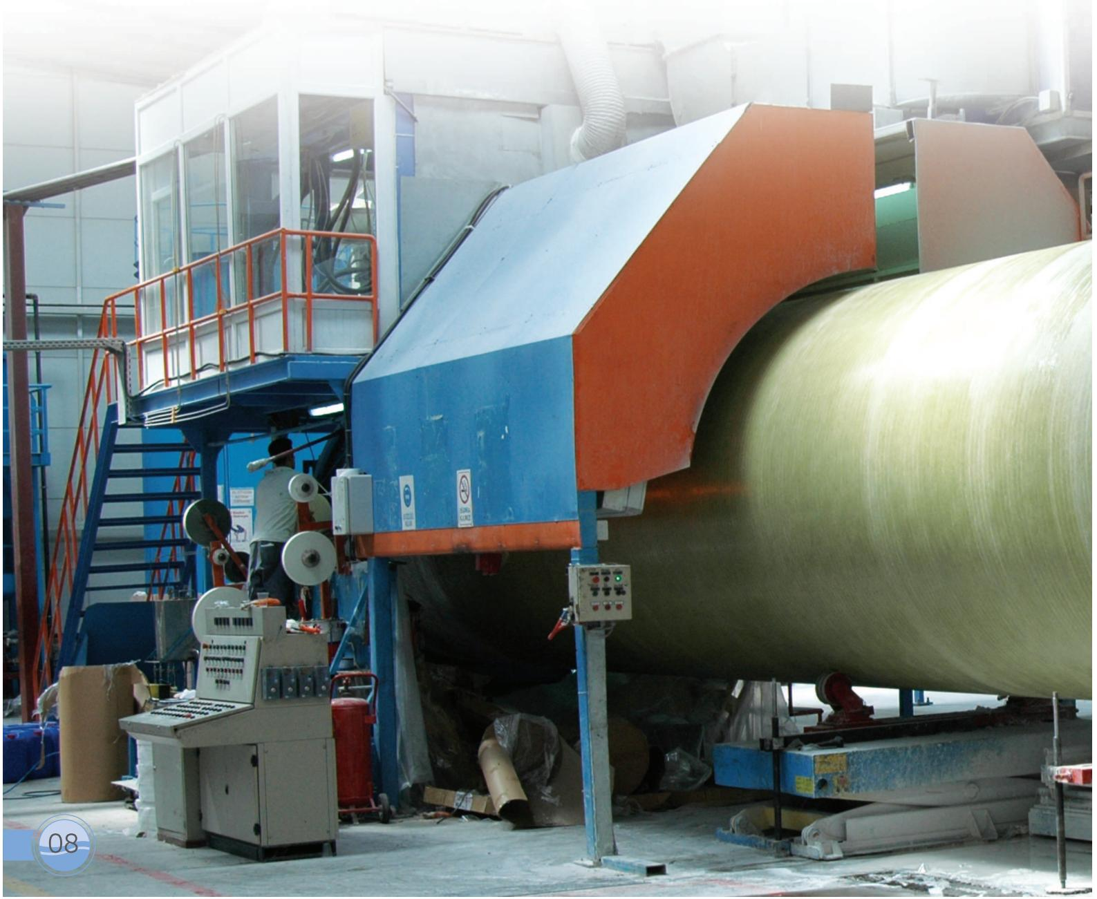
Reçine çıkışı iki farklı hattan sağlanır, yüksek korozif uygulamalarda borunun iç katına özel reçine, gövdesine ve dış kısmına ise normal reçine tatbik edilebilmektedir.
